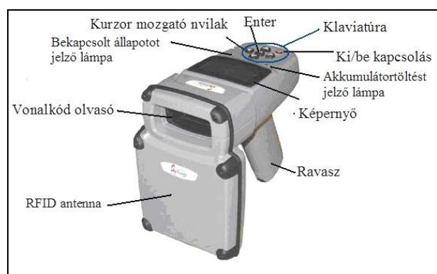
5. ábra A mobil leolvasó a megjelenítő képernyővel
