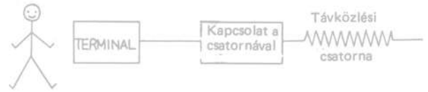
1. ábra On-line csatlakozás elvi vázlatja
